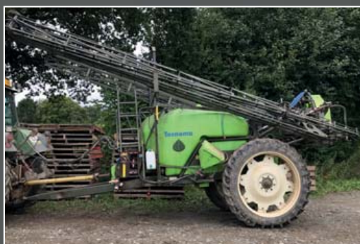
Pulvérisateur à rampes tracté 28 m TECNOMA type 540789 à cuve plastique 3000 l.
