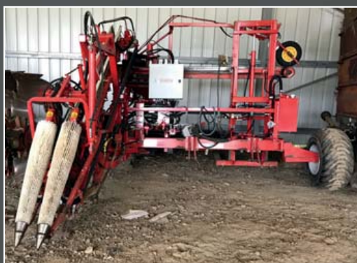
Arracheuse tractée SIMON type RPNA avec tapis convoyeur
