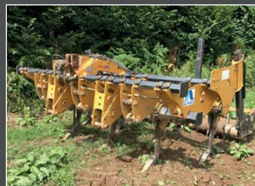
Décompacteur ALPEGO 3 m 7 dents Skat K1 modèle K1-7-300, avec double rouleau packer à relevage hydraulique
