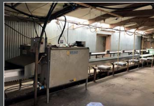
Station de triage poireaux 6 postes comprenant laveuse à doigts caoutchouc inox BRIAND type EPPREM à 2 rouleaux (de 2016)
